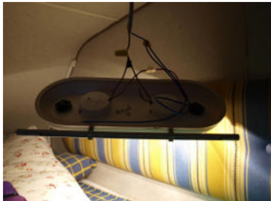
Un interruptor conecta las lámparas incandescentes
